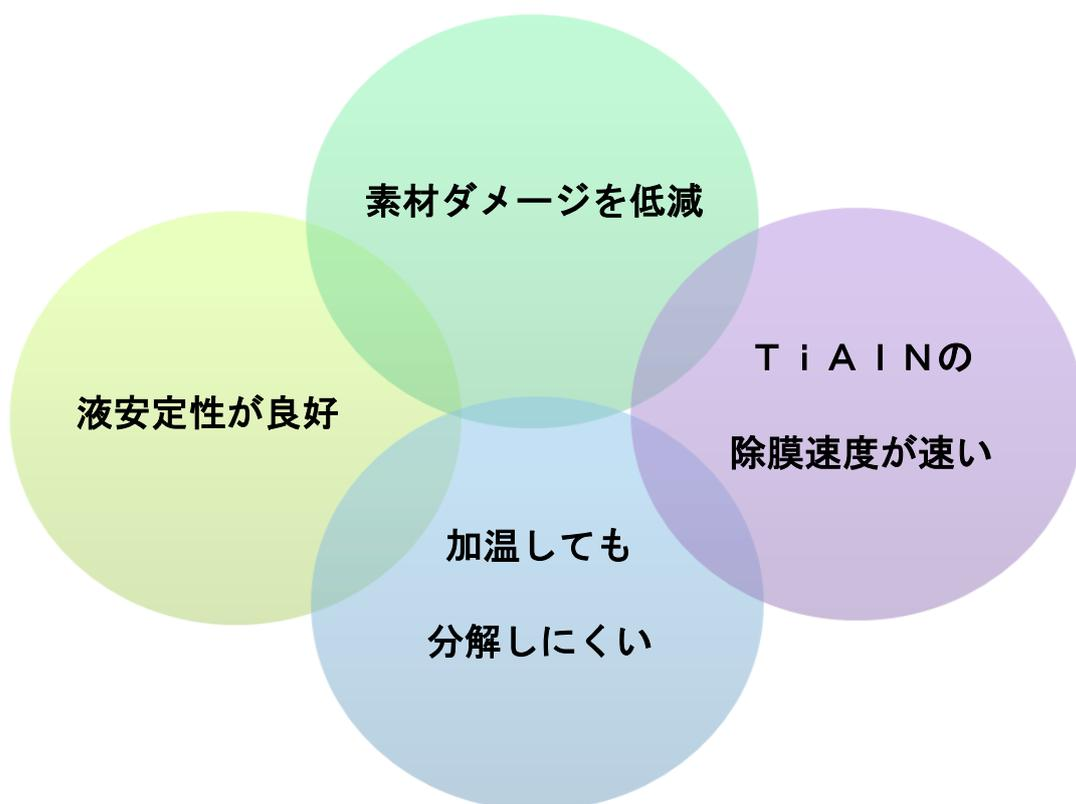
用途:再コーティング前処理工程における、残留コーティング膜の除膜・剥離
